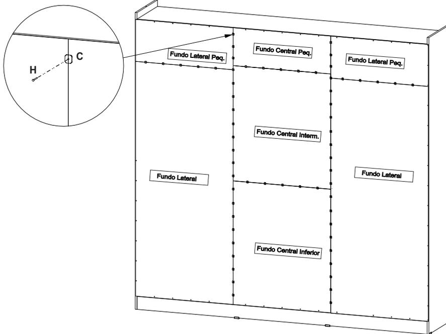
**Passo 10 Fixar as Molduras Conforme Ilustração e em seguida parafusar a Chapa Metálica unindo as duas Molduras.**
