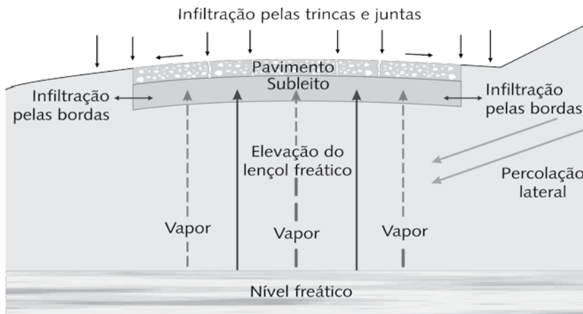
Fig. 1.1 Origens da água na estrutura do pavimento
