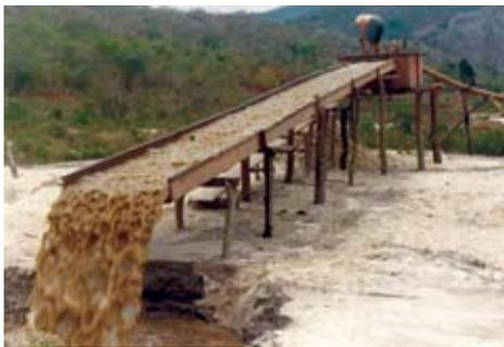
**Foto 25** Sluice para a pré-concentração de ouro e diamante em garimpo, Diamantina, Minas Gerais
