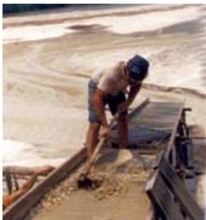
**Foto 26** Limpeza da calba sluice após o processo de concentração
