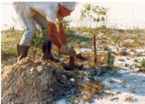
**Foto 19** Amostragem de solo aluvial com trado tipo boca de lobo
