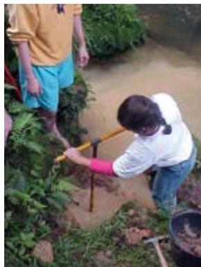
**Foto 20** Amostragem de material de terraço aluvial com trado em concha
