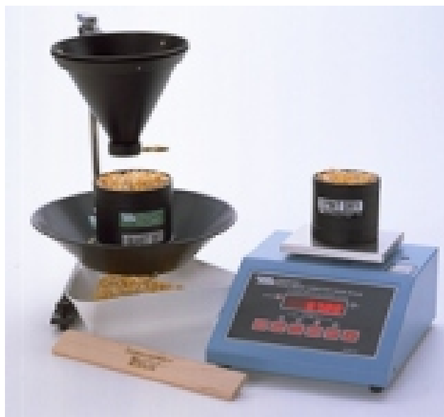
Figura 4 – Balança para determinação do peso hectolítrico (PH).
