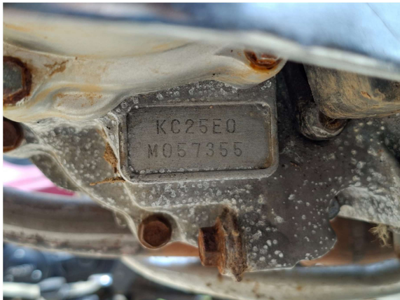
FOTO 04: Detalhe da gravação do número do motor.
