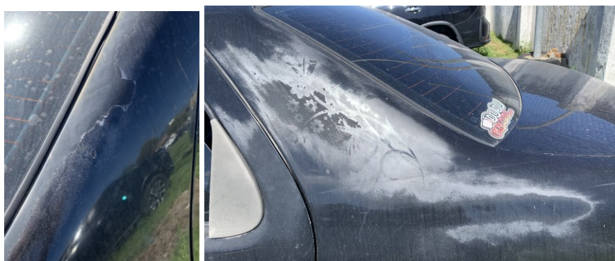
Figura 8 – Danos na pintura.
