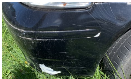
Figura 10 - Danos no para-choque dianteiro
