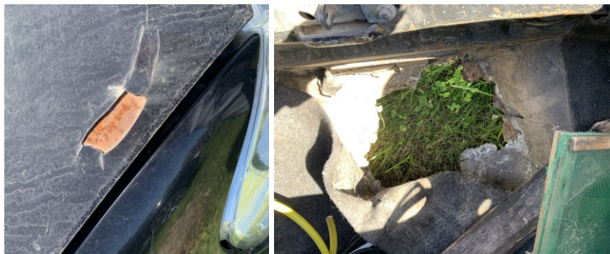
Figura 7 – Pontos com ferrugem e assoalho do porta-malas parcialmente ausente.
