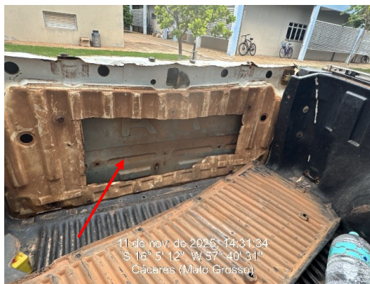
Fotografia 7. Ilustra o corte realizado na estrutura metálica, na parte interna da tampa da carroceria
