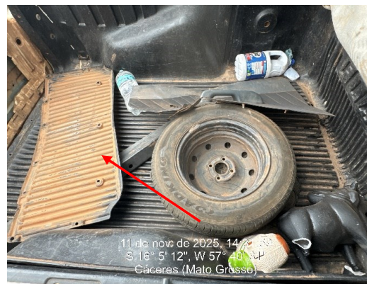
Fotografia 8. Ilustra o protetor da tampa da carroceria, que, quando instalado, oculta a visualização da cavidade gerada a partir do corte na estrutura original do veículo
