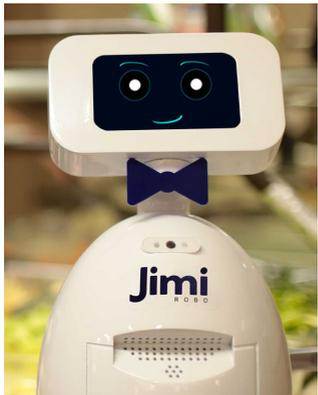
**Robô** que conectado à balança realiza o atendimento, recepciona o cliente com diversas frases de boas vindas, pesa o prato, registra em uma comanda e envia os dados para recebimento no caixa.
