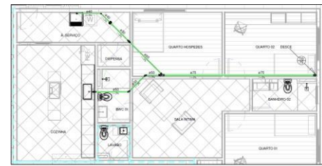
PLANTA BAIXA - TUBULAÇÃO DE GORDURA COZINHA 1 : 75
