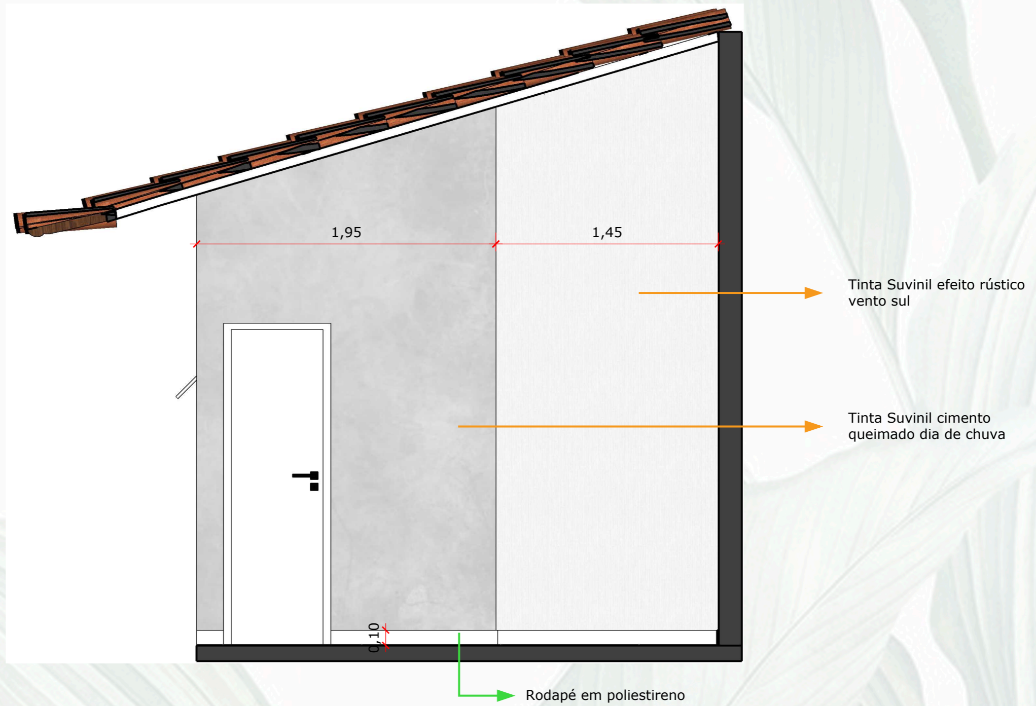
VISTA REVESTIMENTOS - C ESCALA 1.:25
