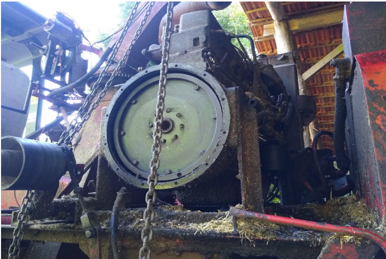
Figura 1: Foto do motor sendo feita a retirada. Fonte: Elaborada pelo autor
