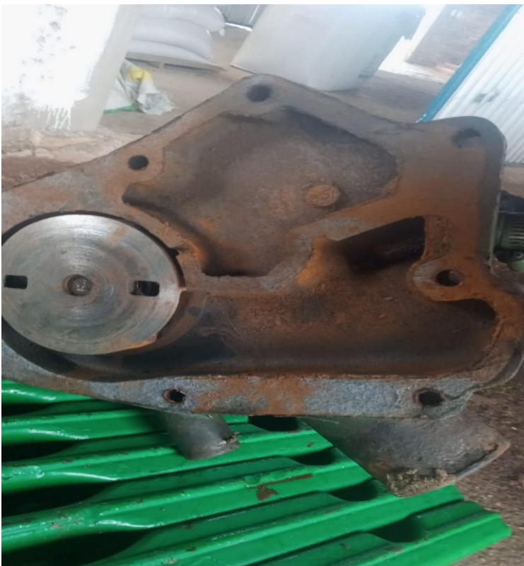
Figura 2: bomba d'água que apresentou defeito. Fonte: Elaborada pelo autor
