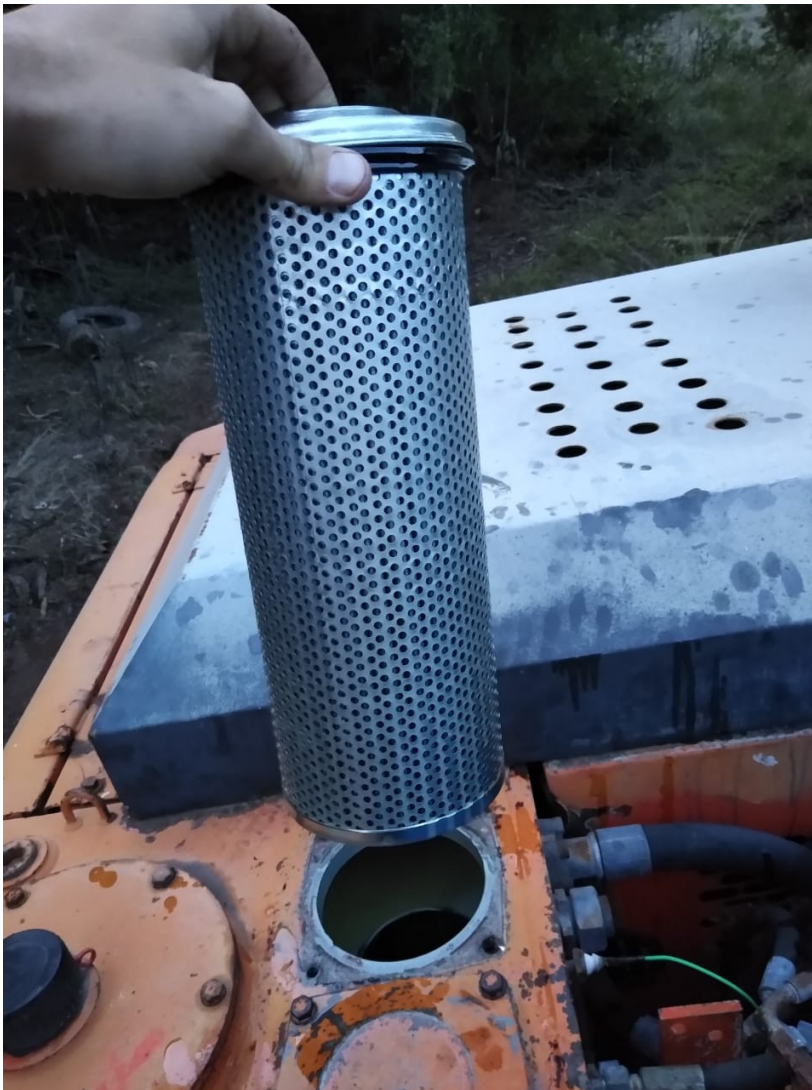
Figura 14: Imagem feita durante a troca de filtros. Fonte: Elaborada pelo autor.
