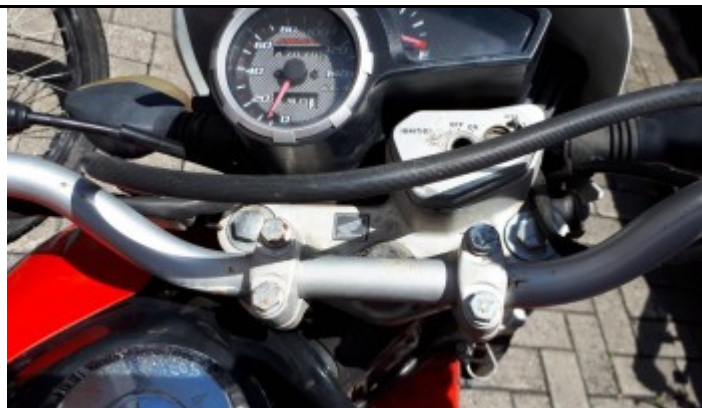
Foto Estrutura Mesa
