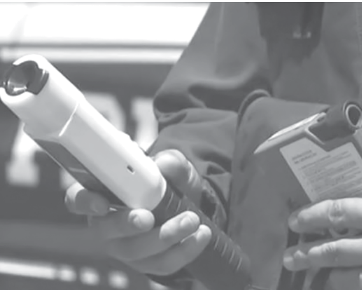
Bafômetro passivo capta o álcool no ar sem que o motorista precise colocar a boca no aparelho
