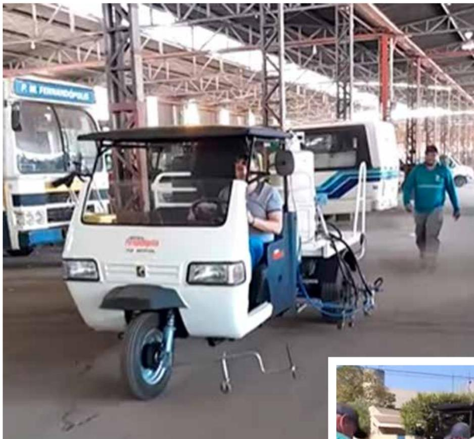
de Fernandópolis tem a capacidade para pintar cinco mil metros por hora. O veículo possui três tanques de armazenamento, cada um com capacidade para 70 litros de tinta. No momento da pintura a máquina aplica simultaneamente o ‘pó de vidro’, fundamental para a visualização das demarcações viárias no período noturno. Além de agilizar o processo de pintura, evitar grandes congestionamentos, o novo veículo também promove uma economia de uso e gasto com as tintas pelo seu sistema automatizado.
