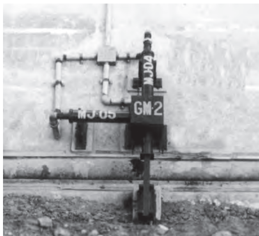
FIG. 9.13 Medidor triortogonal na barragem de Xingó
