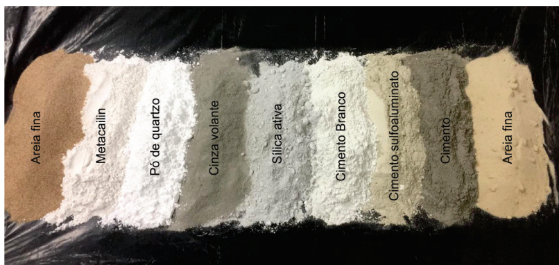
Figura 77 – Principais materiais utilizados nas misturas de UHPC
