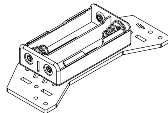
O centro da peça D01 vem fixo, mas pode ser destacado. Nesta montagem, vamos usa-lo como guia para os parafusos. Assim o suporte ficará alinhado.
