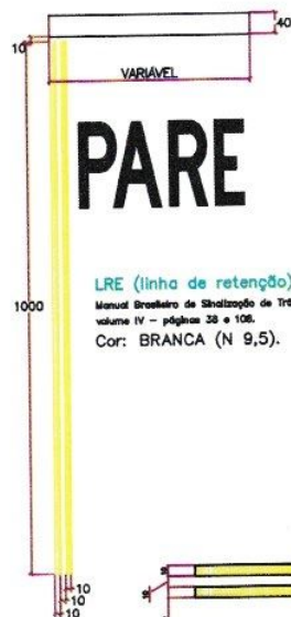
Manual Brasileiro de Sinalização de Tráfego - volume IV - páginas 46 e 47. Cor: AMARELA (N 9,5). Detalhe da LFO-3 (linha de fluxos opostos)
