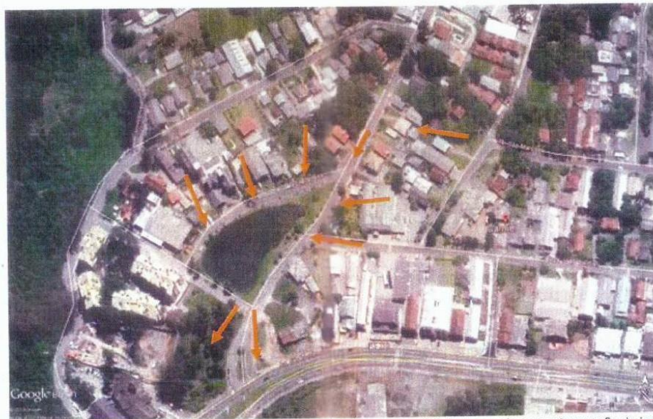
Figura 1. As setas indicam a tendência do escoamento das águas superficiais de acordo com a topografia do local.
