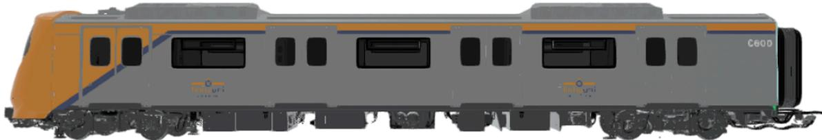
Fabricados em aço inoxidável, outra característica dos trens é a resistência: as estruturas das composições têm durabilidade de mais de 40 anos, além de apresentarem menor peso se comparadas com modelos fabricados em aço carbono.
