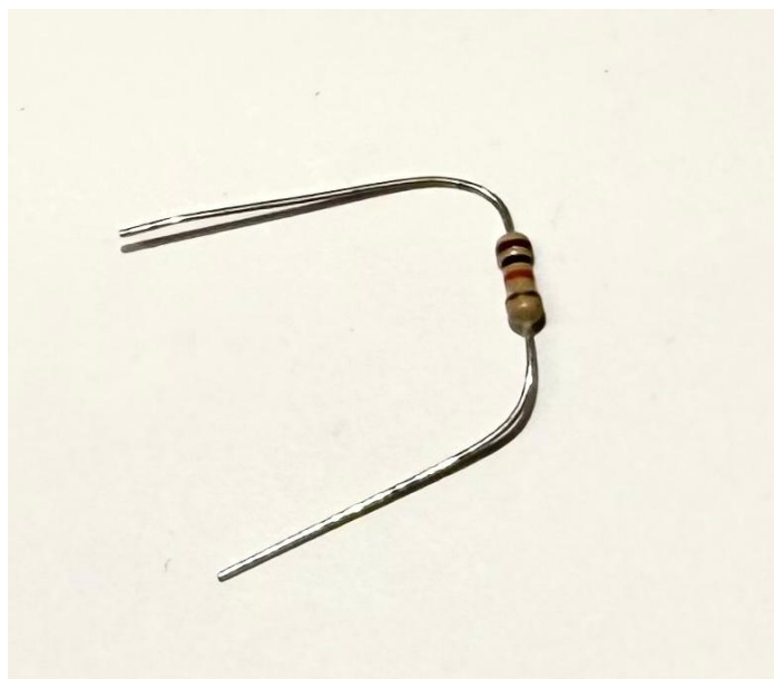
Figura 1 - Resistor de 1kΩ
